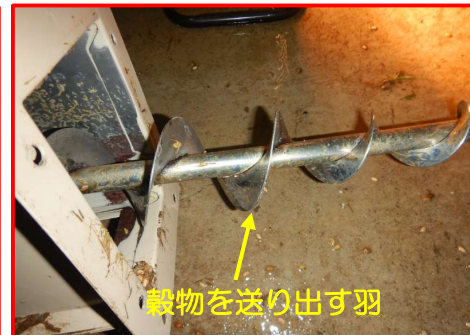
写真3 羽の摩耗状況
