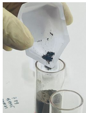
前培養後の土壌試料に肥料を投入
