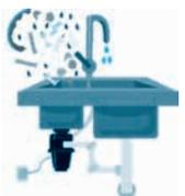
ディスポーザーとは、台所のシンク(流し台)の排水口に取り付けて、生ごみを細かく砕いてから直接下水道に流す装置です。
