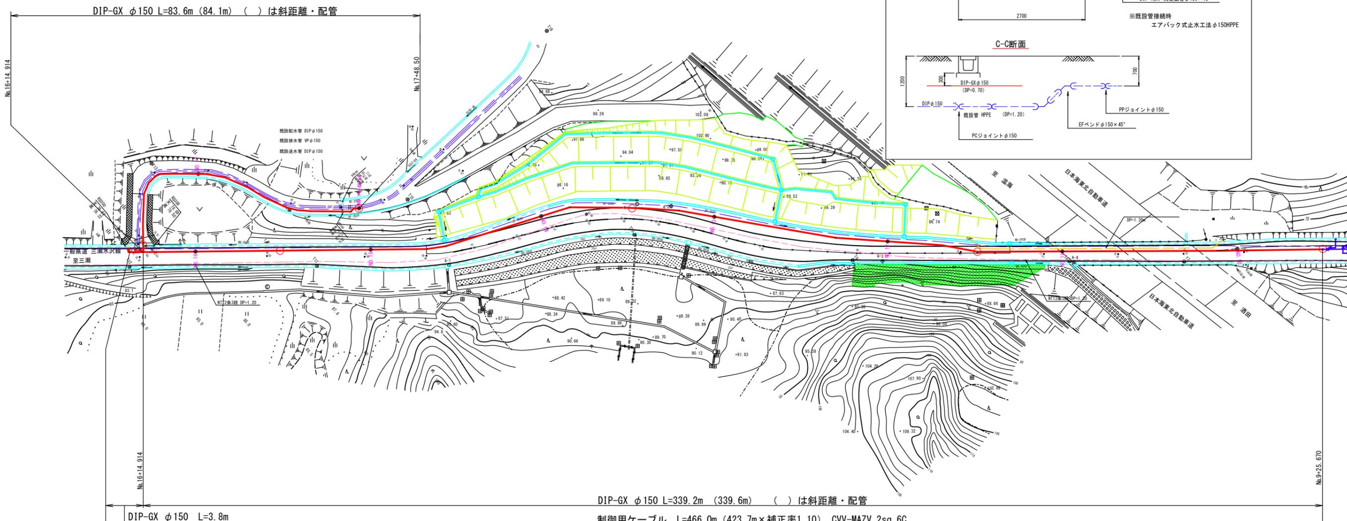
DIP-GX φ150 L=339.2m (339.6m) ( )は斜距離・配管
