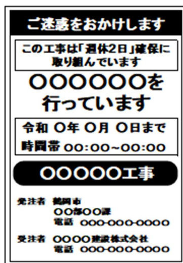
(図) 工事標示板への明示の例
