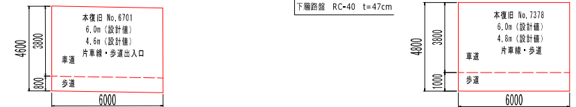
本復旧 MHID:6701, 7378 2号マンホール(N5交通) 本復旧幅 No.6701 4.6m (設計値) No.7378 4.8m (設計値)
