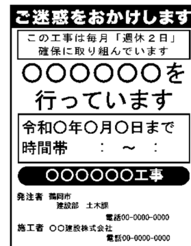
(図) 工事名標示板への明示の例
