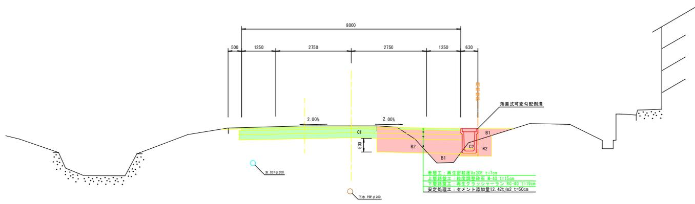
表層工 : 再生骨材厚A<sub>2</sub>20F t=7cm
