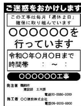
(図) 工事名標示板への明示の例
