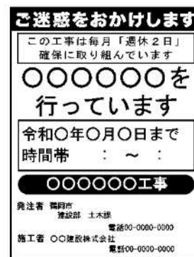
(図) 工事名標示板への明示の例
