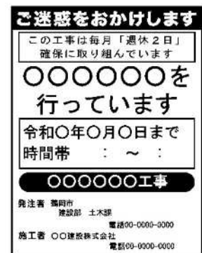
(図) 工事名標示板への明示の例
