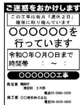
(図) 工事名標示板への明示の例
