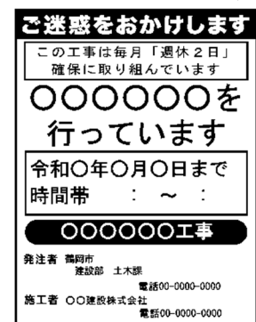
(図) 工事名標示板への明示の例
