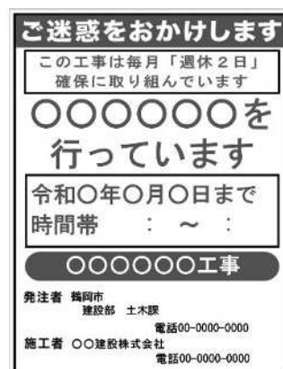
(図)工事名標示板への明示の例
