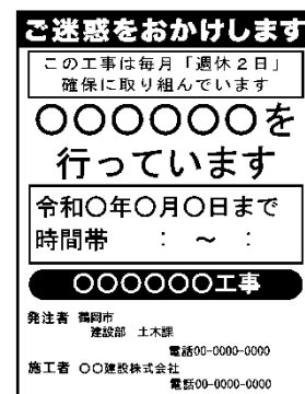
(図)工事名標示板への明示の例
