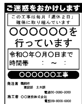
(図) 工事名標示板への明示の例
