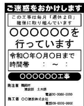
(図) 工事名標示板への明示の例
