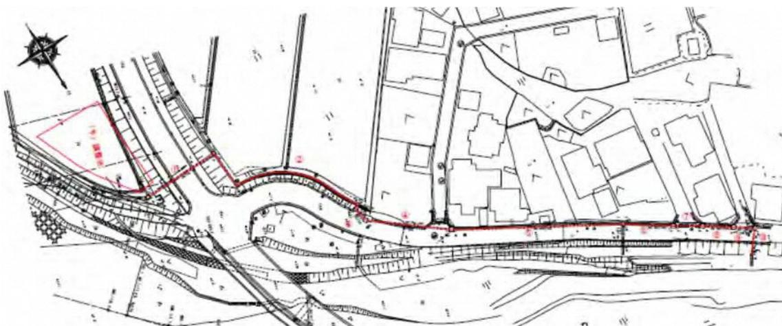
この下流水路に流入する従来の排水に事業地の排水（0.419m<sup>3</sup>/s）をそのまま流下させた場合は流下能力を上回ってしまうため、検討の結果 0.181m<sup>3</sup>/s まで調節するものとして調整池容量を算定する。
