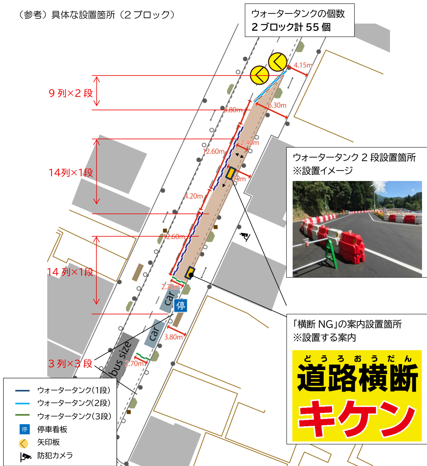
図 具体的な設置箇所 (1/2)
