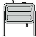
▼家庭では ▼灯油をホームタンクからポリ容器等に小分けする際は絶対にその場を離れず、最後に元栓をしっかりと閉める ▼ホームタンクの周囲は除雪を小まめに行い、落雪による開栓や機器の破損を予防する ▼ホームタンクや配管に腐食や亀裂がないかを点検する（地中に埋設している配管は特に注意する） ▼ホームタンクの下に防油堤を設置する。また、給油栓に自動停止給油器を取り付ける
