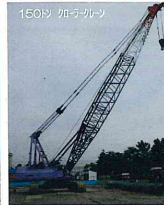
写真：150ト クローラクレーン
