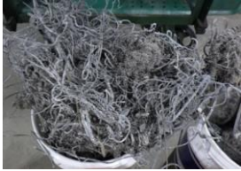
ごみ焼却施設の灰の中から発見された金属類(番線・刈払い機の刃などと思われる)
