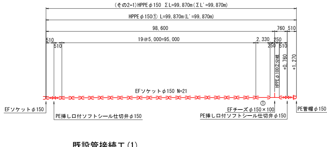
既設管接続工 (1)
