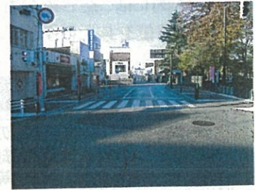
市道 「南町荒町大宝寺町線」 (都市計画道路) L=400m W=11.0m 歩道=両側 2.25m 全面融雪道路 (地下水利用)
