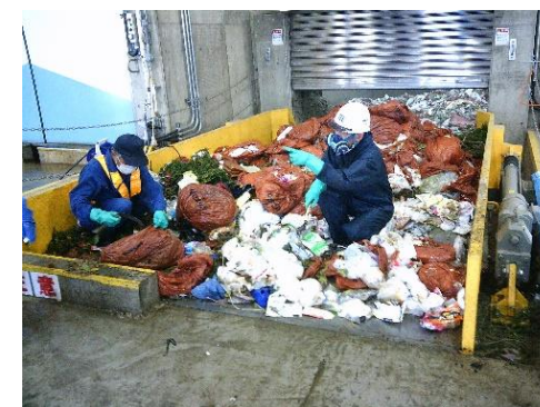
展開検査の様子
